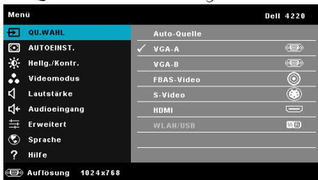
**VGA-A**—Durch Drücken von
