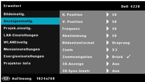
**H. POSITION**—Mit  bewegen Sie das Bild nach rechts, mit  bewegen Sie das Bild nach links.
