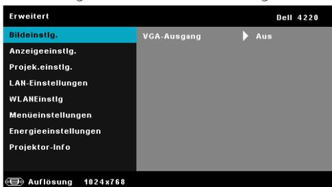
**VGA-AUSGANG**—Wählen Sie zum De-/Aktivieren der VGA-Ausgangsfunktion im Bereitschaftsmodus des Projektors Ein oder Aus. Standardeinstellung ist Aus.
