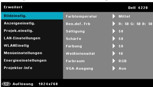
**FARBTEMPERATUR**—Hier können Sie die Farbtemperatur einstellen. Der Bildschirm erscheint bei höheren Temperaturen kühler, und bei niedrigeren Temperaturen wärmer. Bei einer Einstellung der Werte im **Farbeinst.** Menü, wird der Benutzermodus aktiviert. Die Werte werden im Benutzermodus gespeichert.
