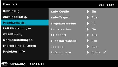
**AUTO-QUELLE**—Wählen Sie zum Sperren des aktuellen Eingangssignals **Aus** (Standardoption). Falls Sie die Source-Taste drücken, wenn der **AUTO-QUELLE**-Modus auf **Aus** eingestellt ist, können Sie das Eingangssignal manuell auswählen. Wählen Sie zur automatischen Erkennung verfügbarer Eingangssignale **Ein**. Wenn Sie bei eingeschaltetem Projektor die Taste **QUELLE** drücken, findet das Gerät automatisch das nächste verfügbare Eingangssignal.
